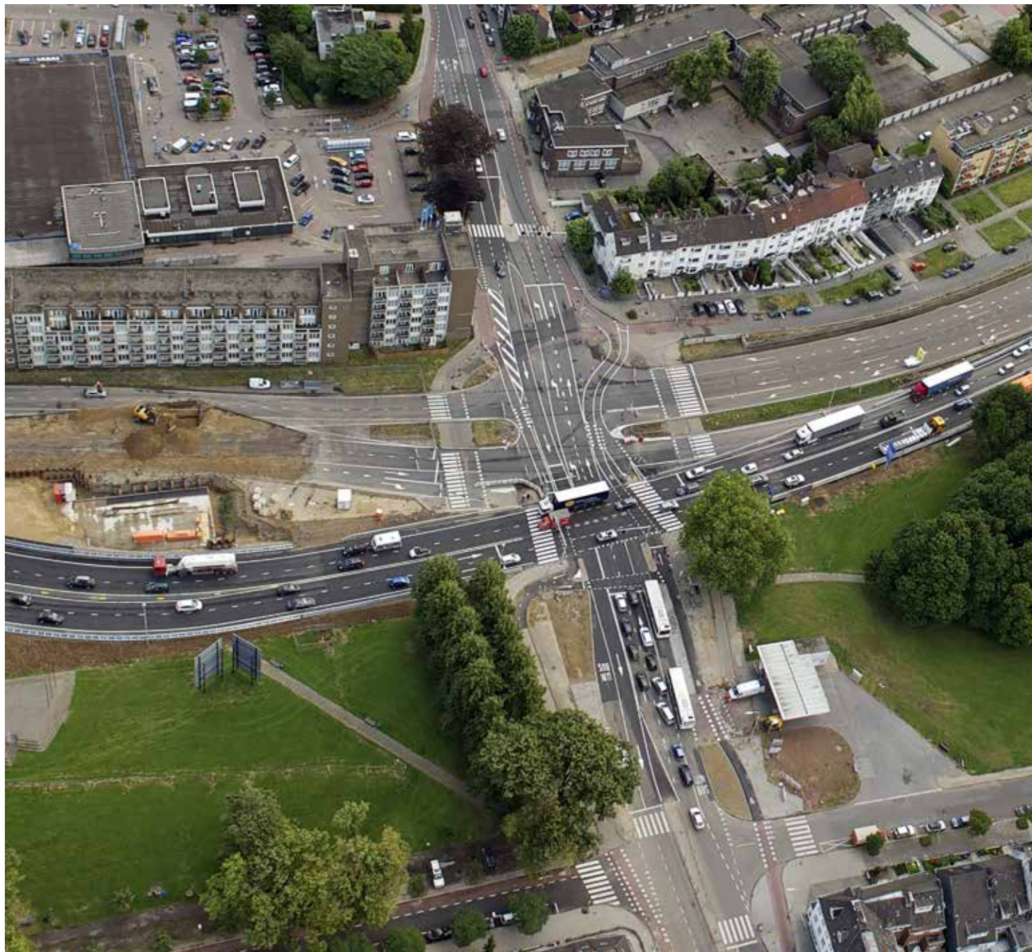
Kruispunt Scharnerweg is 'koudgemaakt'. Verkeer mag alleen nog rechtdoor rijden of recht oversteken (2012).
