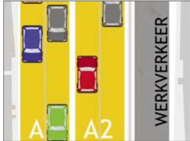
Figuur 2: duidelijke scheiding van tijdelijke N2 (gele banen) en werkverkeer voor de tunnel (grijze baan)
